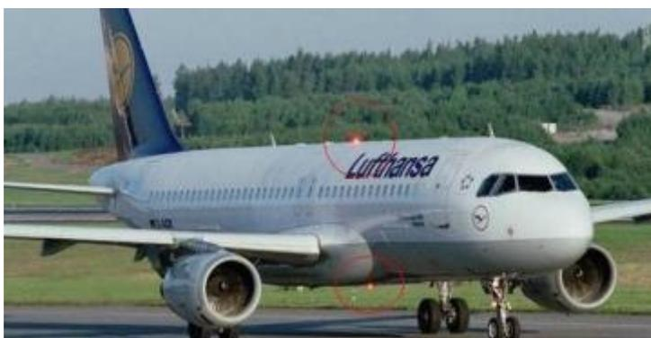
Figura 17 - Anti collision light
