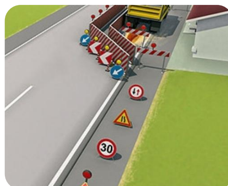
Figura 9 -Segnaletica provvisoria di cantiere
