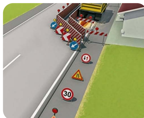
Figura 9 -Segnaletica provvisoria di cantiere
