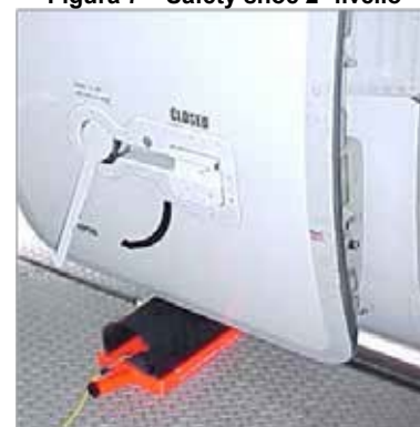
Figura 8 – Posizionamento corretto della safety shoe
