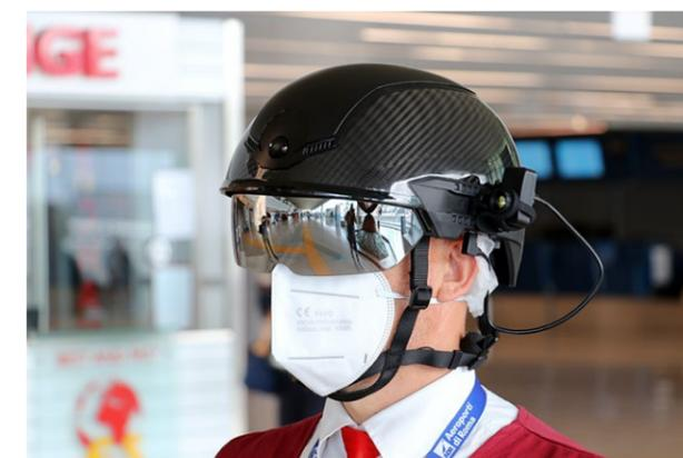
Smart Helmet per il controllo della temperatura corporea
