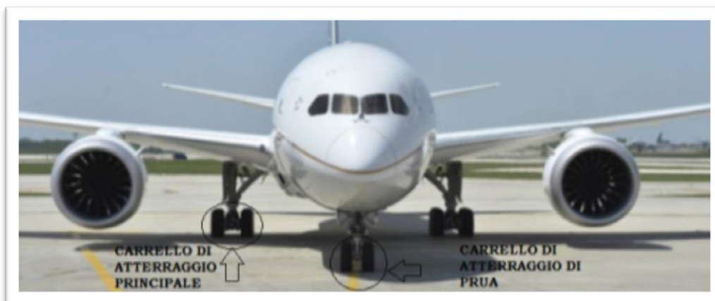
Figura 19 - Carrello di atterraggio
