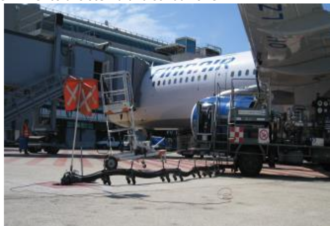
Figura 55 - Cisterna interrata e rifornimento
